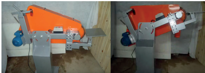
Figura 5: Dinâmica de mudança de altura do equipamento proposto.
