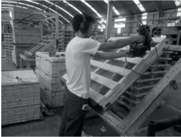
Figura 2: Embalagem sendo montada em uma banca inclinada.
